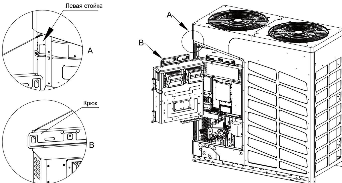
При подключении кабеля питания оставьте достаточную длину снаружи для удобства поворачивания электрической коробки.
