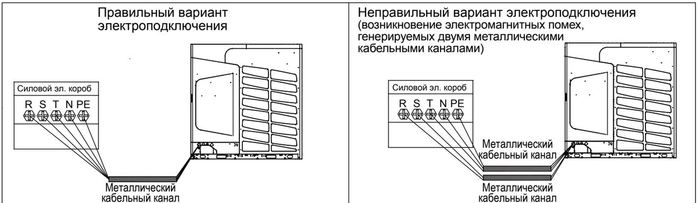
7. В случае комбинирования нескольких блоков запрещается осуществлять подачу питания от ведущего наружного блока ведомому блоку (см. следующую схему).
