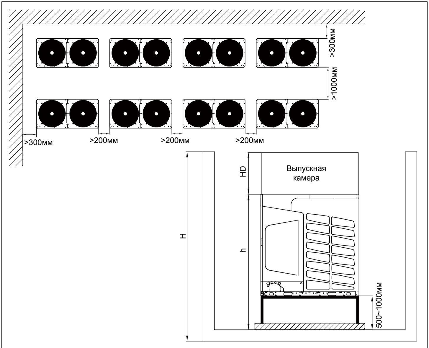
4. Наружный блок должен быть защищен от воздействия сильных ветров. Нельзя допускать попадания потока ветра в поток заборного воздуха блока, поскольку это может повлиять на функцию оттаивания и сопряженные с ней функции.
