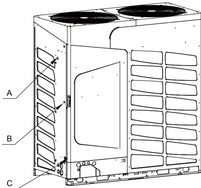
2. При повороте сервисной панели в направлении, указанном стрелкой, примерно на 40°, правосторонние фиксаторы панели разомкнутся, и панель можно будет снять.
