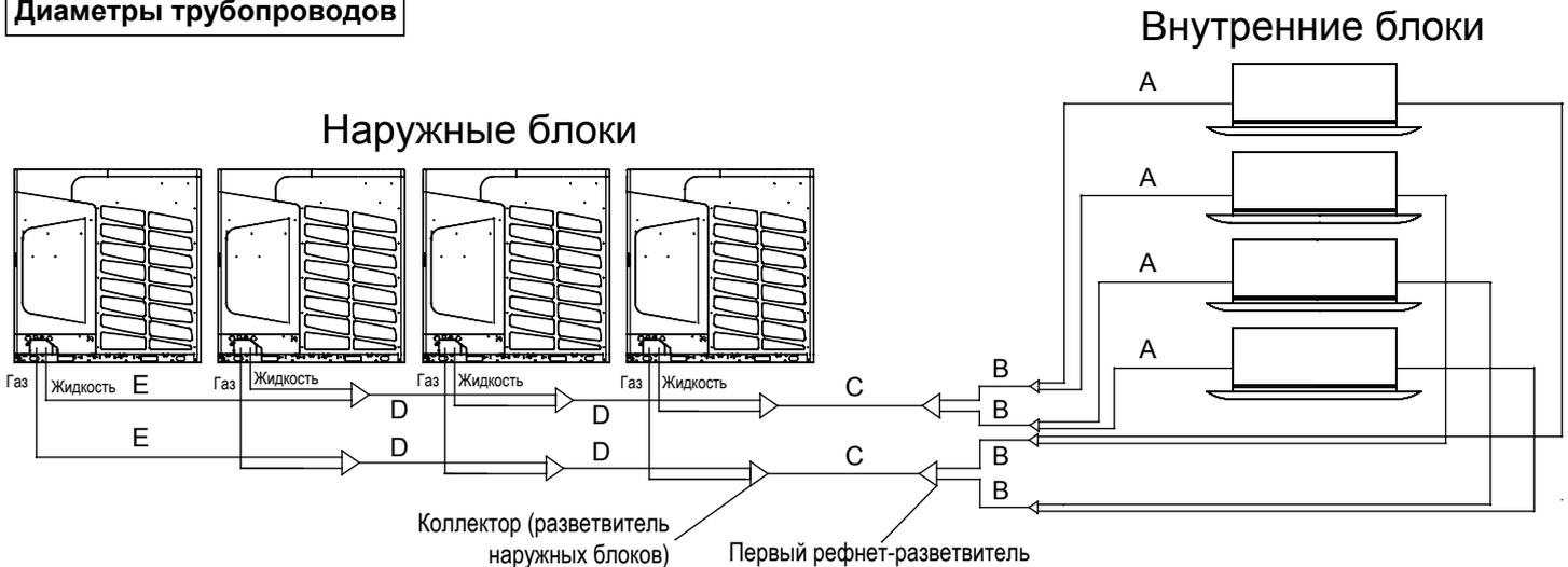
1. Диаметр трубопровода «А» между внутренним блоком и разветвителем (определяется типоразмером внутреннего блока).
