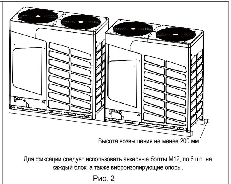
9. Наружный блок должен быть надежно закреплен. Резиновая виброизолирующая подушка толщиной 20 мм и шириной 80 мм должна быть положена между опорной рамой чиллера и фундаментным основанием. Монтажные схемы показаны ниже. Специальные указания:
